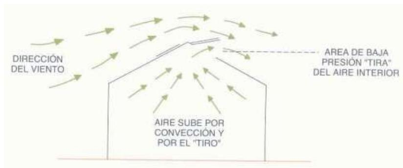
Figura 8. Esquema da sucção criada pelo vento do ar quente existente dentro do ambiente protegido pela abertura superior (lanternim). Fonte: Castilla, 2005.
